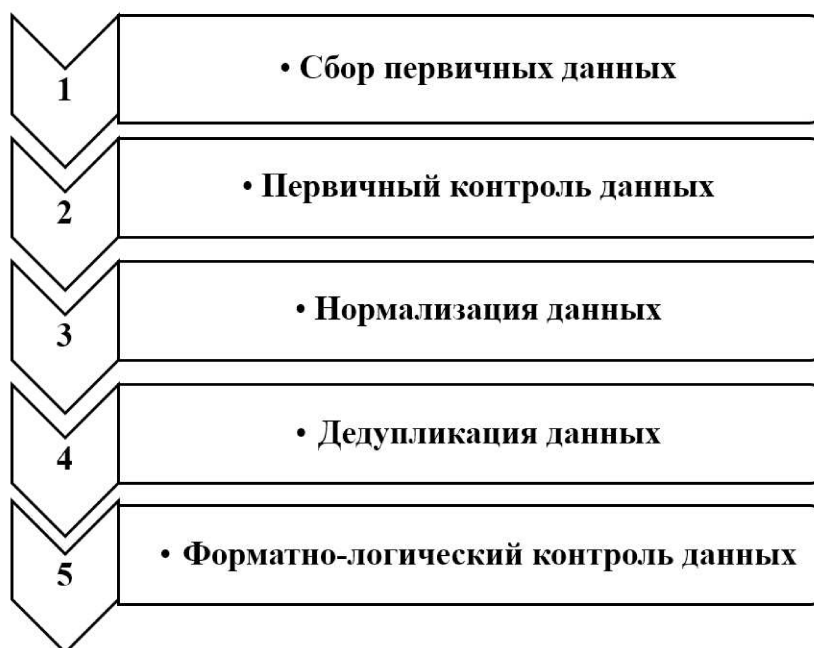
Рис. 2: Этапы обработки данных мониторинга элементов ИТС
