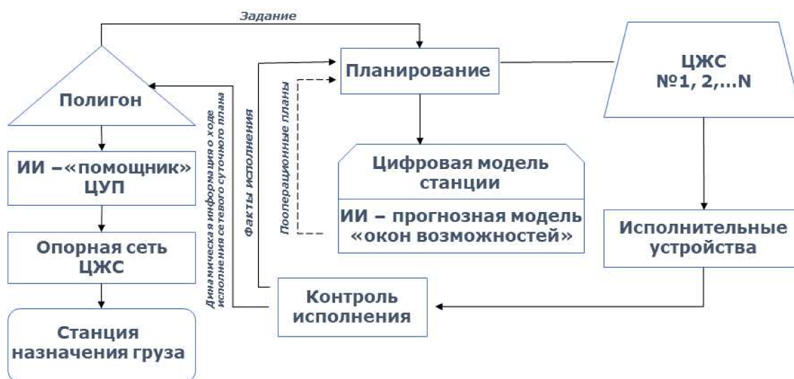
Рис. 2: Реализация задач планирования и рационального продвижения вагонопотоков на опорной сети цифровых железнодорожных станций
