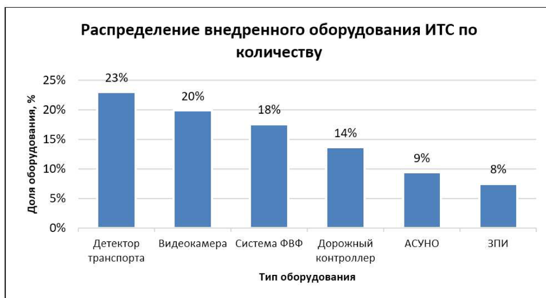
Рис. 3: Распределение внедренного оборудования ИТС по количеству
