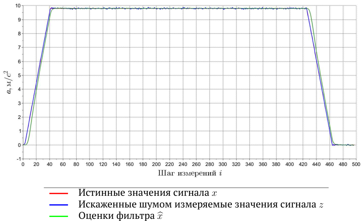
Рис. 4: Фильтрация модели сигнала акселерометра при помощи предложенного алгоритма
