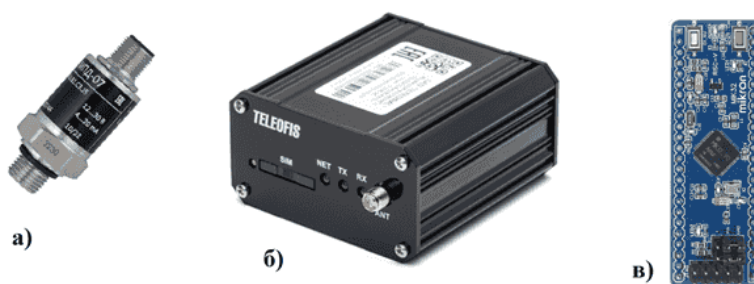
Рисунок 3. Датчик давления МПД-07 (а), GSM/GPRS модем TELEOFIS RX108-R4 (б) и микроконтроллер МК32 «Амур» (в)
