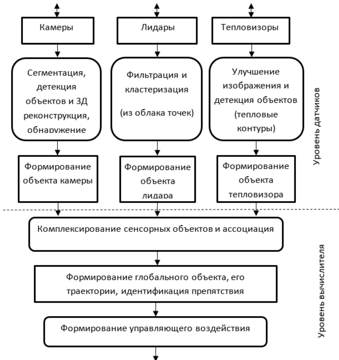
Рисунок 5. Блок-схема работы бортовой СТЗ для обнаружения препятствий
