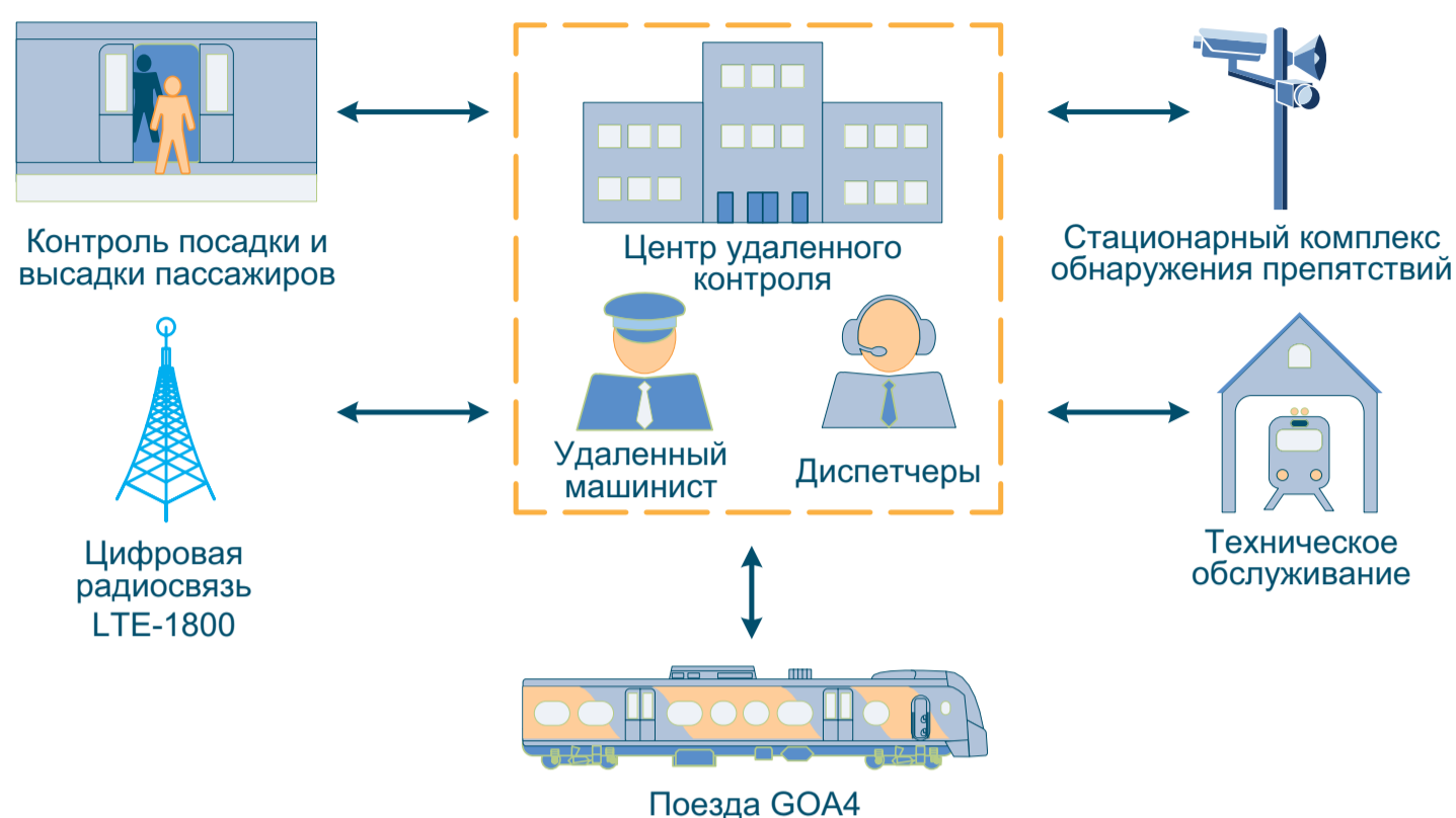
Рисунок 4. Архитектура беспилотной системы управления на МЦК
