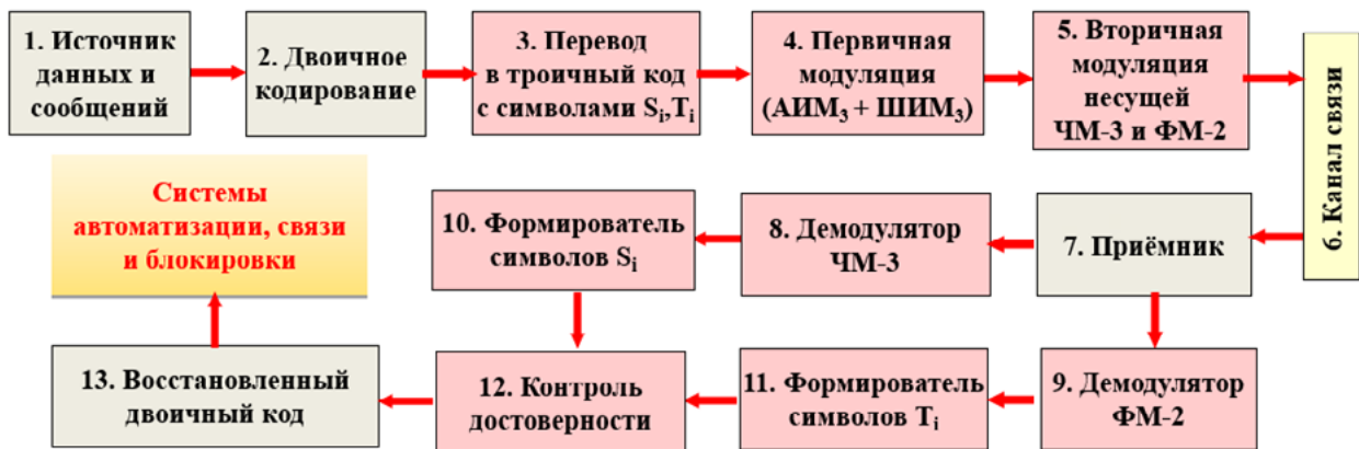
Рис. 5 – Блок-схема реализации предлагаемой технологии передачи информации
