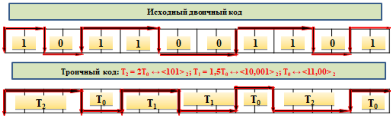
Рис. 2 – Импульсные формы представления символов исходного двоичного кода (верхняя эпюра) и символов T_i , i = 0, 1, 2 предлагаемого троичного кода (нижняя эпюра)
