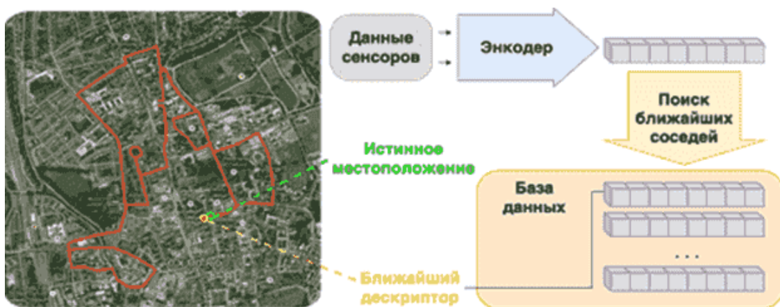
Рисунок 1. Задача мультимодального распознавания места по разреженной 3D-карте
