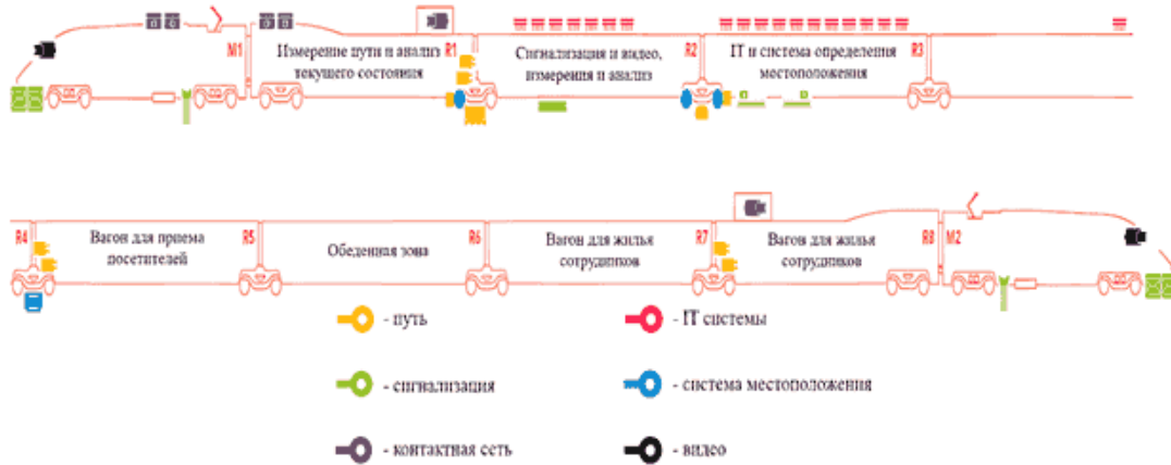
Рисунок 1. Схема расположения вагонов и датчиков «IRIS-320»
