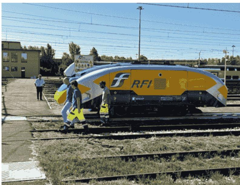
Рис. 9 – Диагностический комплекс URV (Unmanned Railway Vehicle) от RFI - FSI Group
