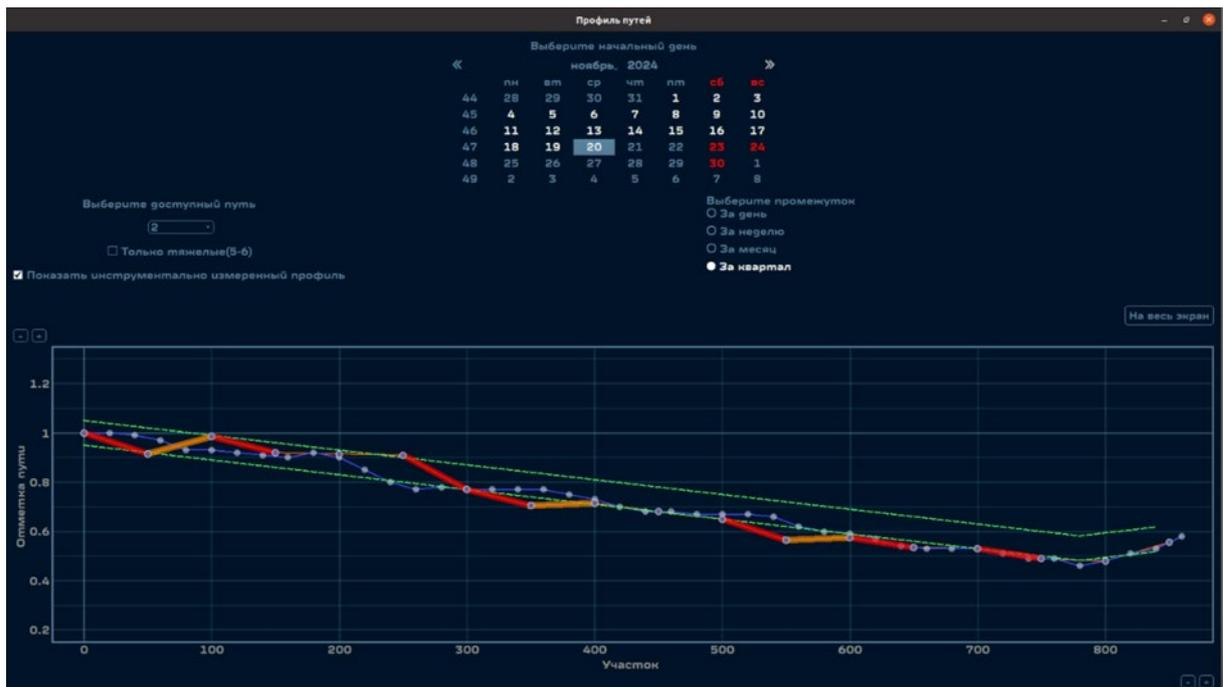
Рисунок 6. Профиль второго сортировочного пути нечетной системы ст. Кинель после выправки (20 ноября 2024 года)
