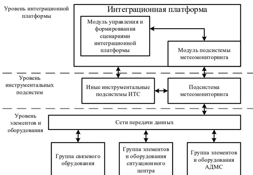
Рис. 1 – Архитектура подсистемы метеомониторинга
